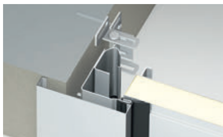
Монтаж перед проемом При отсутствии боковых пристенков
