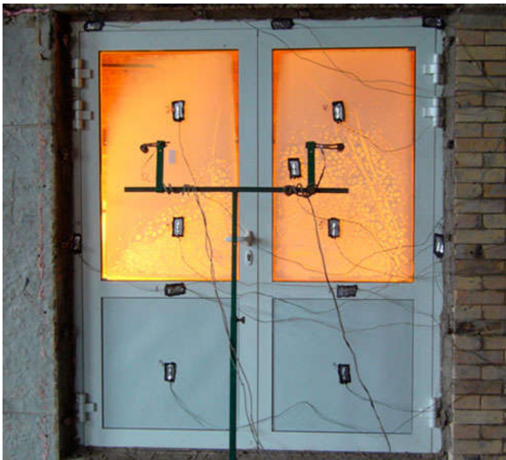
Рис. 1. Успешные испытания двухстворчатых дверей на класс огнестойкости EIW30
