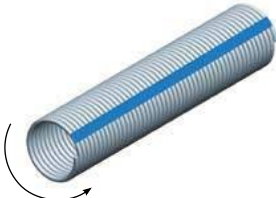
ПРУЖИНА С ПРАВОЙ НАВИВКОЙ - R (МАРКИРУЕТСЯ ЛЮБЫМ ДРУГИМ ЦВЕТОМ)
